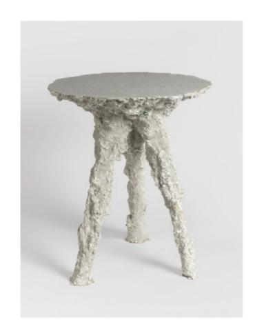
我们尝试用装置及实验家具的形式,向社会传递巨大产业背后体统的破碎崩离,揭示社会所面临的社会问题与环境问题,不可降解的废弃日用瓷被丢弃被埋藏,并从材料学的角度出发,尝试废弃日用瓷与混凝土的结合可能性。
