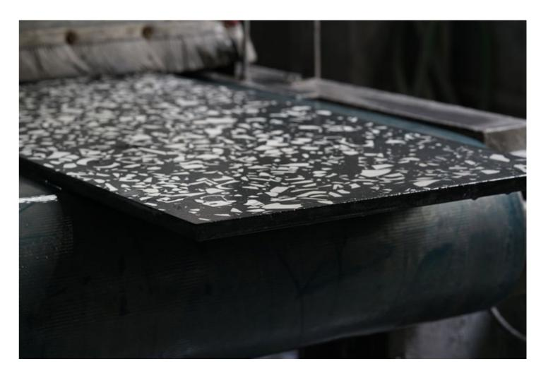
将不能降解与难以二次利用的日用废瓷粉碎重新利用,经过不断配比的材料实验,我们以约 40%的回收日用废瓷与调配的高性能混凝土混合,进行批量化生产。表面经打磨抛光而成,极富表现力。墙地面装饰是建筑材料使用量最大的材料之一,我们通过庞大需求的角度将再生材料介入其中,才能真真正正将不可降解的陶瓷消耗掉,真切地影响到社会现实。
